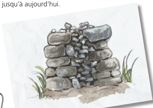
Coupe d'un muret montrant les deux parements latéraux construits, enfermant un remplissage de pierraille en vrac.
